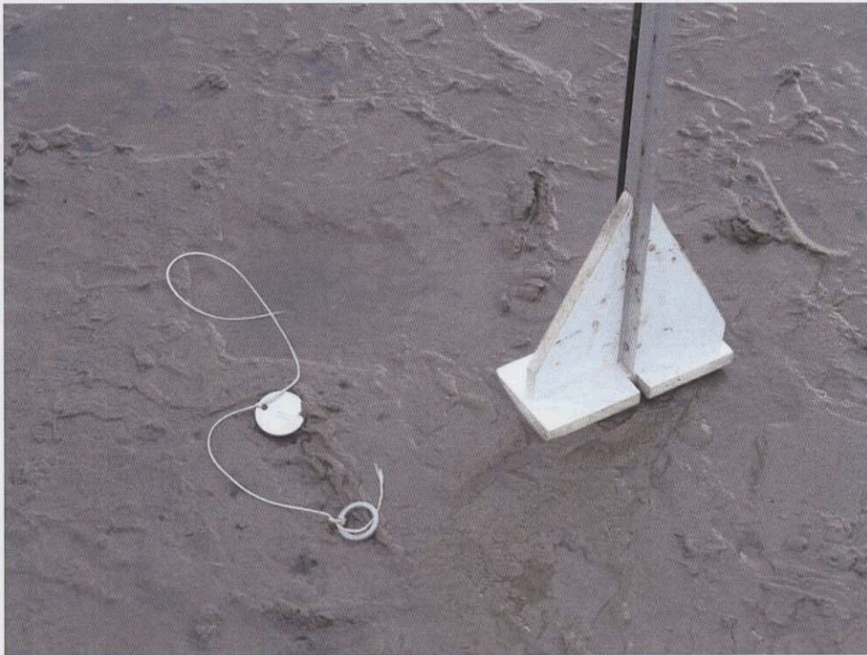
Foto 2 Geplaatste spijkerpunt, draad, meetring en label (windrichting), meetlingaal waar hoogte van Wad tot ring gemeten wordt
