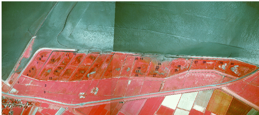
Figuur 3.14 Luchtfoto van de Peazemerlannen. De foto is in zogenaamde "false color" waarmee plantengroei goed wordt weergegeven. Linksonder ligt het dorp Peazens. Direct ten noorden van de zomerpolder. De polder wordt oost-west doorsneden door een zomerkade die de kwelder begrensd (donkerderrood). De twee breuken in de dijk zijn zichtbaar als een donker deel in de buitenste bedijking.
