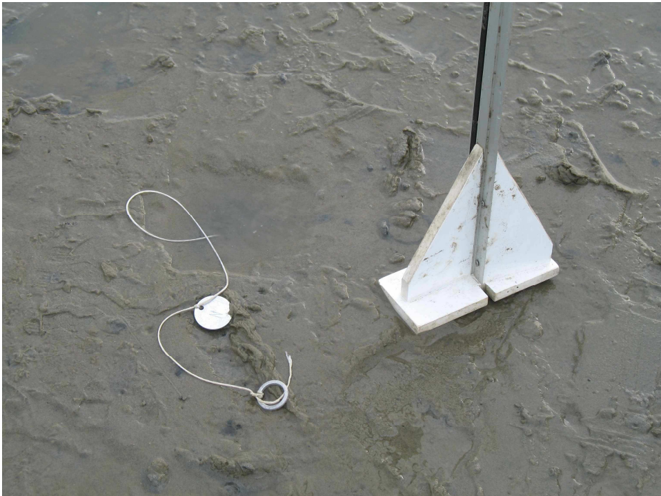
Foto 2 Geplaatste spijkerpunt, draad, meering en label (windrichting), meetlingaal waar hoogte van Wad tot ring gemeten wordt
