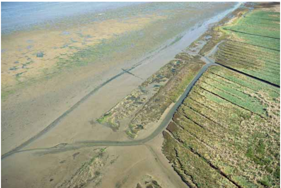
Foto 5.2 Vliegerfoto van 16 oktober 2005 van de restanten van de weggeslagen zomerkade en het voorliggende wad ter hoogte van de dijkdoorbraak in het westen. (© Jaap de Vlas)
