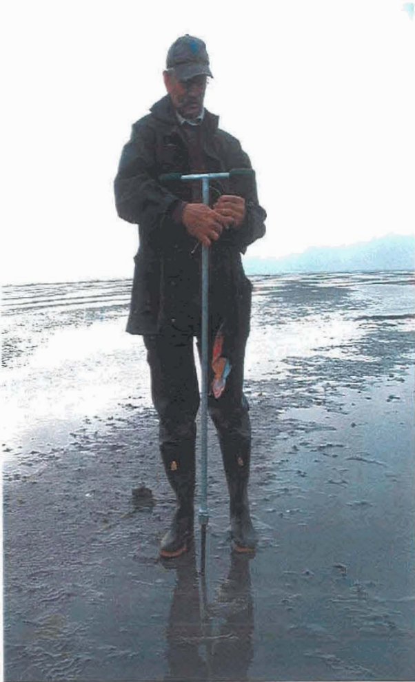
Het plaatsen van een spijkerpunt
