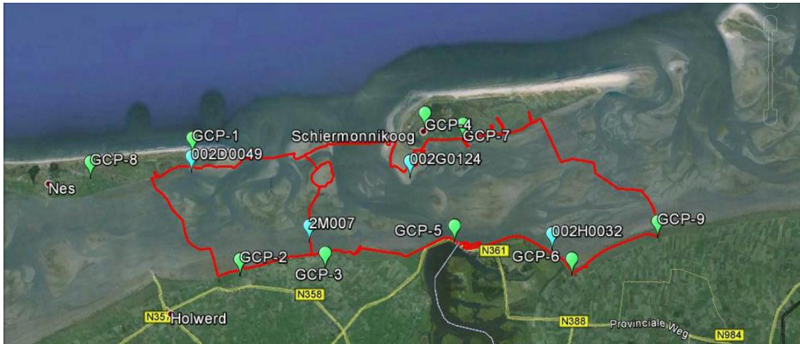
Figuur 2.3 Overzicht van ground control locaties, bron: Fugro (2013), blauw markers zijn plots op het wad, groene markers verwijzen naar de ground control plots (GCP met nummer).
