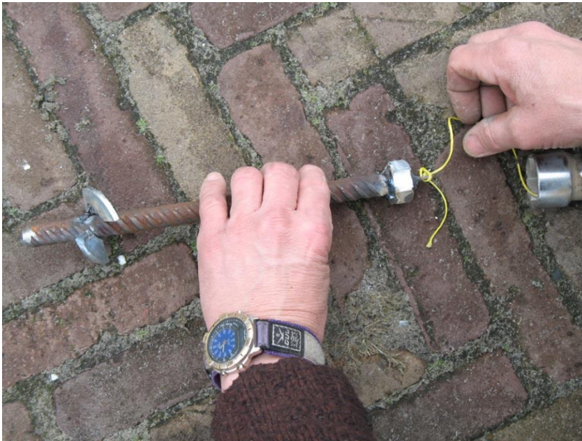
Figuur 2. Eigenbouw grondanker waaraan niet rekkend meettouw bevestigd wordt. Rechts de dop aan het uiteinde van de T-grondboor waarmee het anker in de bodem geschroefd wordt (figuur 3). Homemade groundanchor to which a non-elastic string is attached. At right the socket at end of long T-drill with which the anchor is drilled into the soil (figuur 3).
