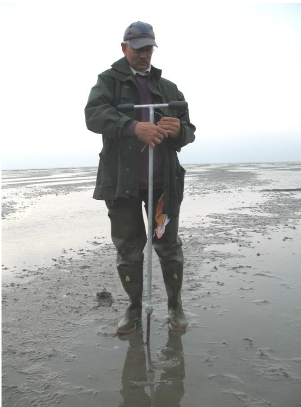
Figuur 3. Grote T-dopsleutel met dop aan uiteinde waarmee grondanker in de bodem geschroefd wordt. Het meettouw loopt door de grondboor en hieraan wordt later een identificatieblikje en aluminium afleesring bevestigd. Long T-drill with socket at the end with which the anchor is drilled into the soil. The measuring string runs through T-drill and to this the identification and measuring labels (aluminium) will be attached.
