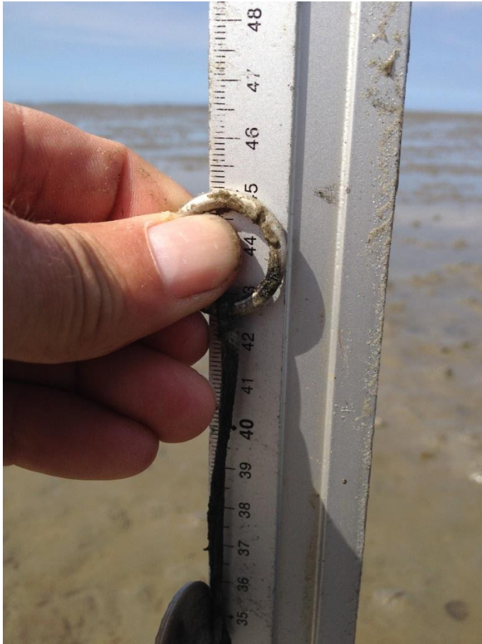
Figuur 6. Meetliniaal met brede meetvoet (niet zichtbaar). Deze wordt steeds op dezelfde wijze op de bodem gezet waarna de lengte van het meettouw langs de schaal wordt afgelezen. In dit geval 45,1 cm.. Ruler with broad foot (not visible) at base. This is always placed at the soil in the same way and then the length of the rope can be read at the ruler. In this case 45,1 cm..
