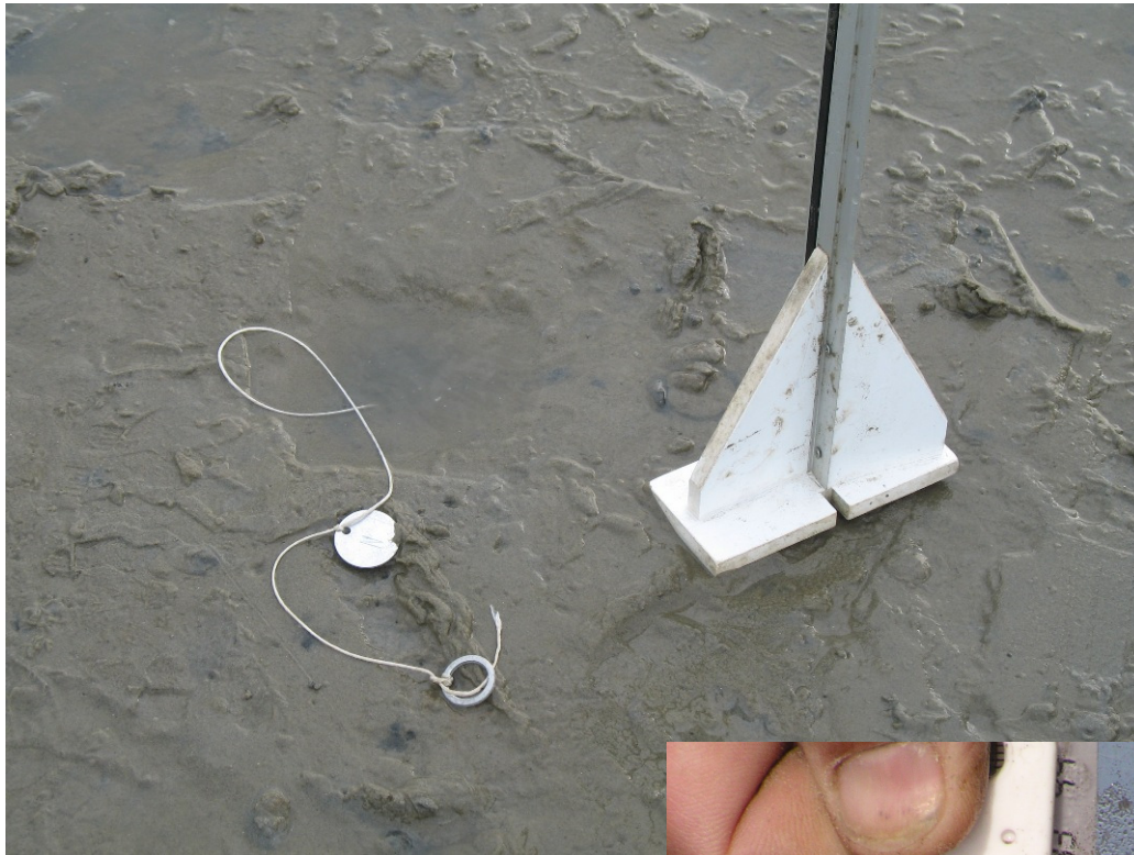
Foto 4. Meetlineaal met meetvoet. Deze wordt steeds op dezelfde wijze op de bodem gezet waarna de lengte van het meettouw langs de schaal wordt afgelezen.
