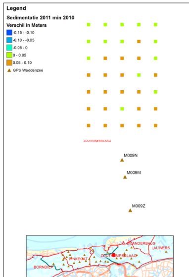
Fig.4.13 M009 Deformatie in periode 2010-2011 GPS meting 2010-2011: Daling 1mm
