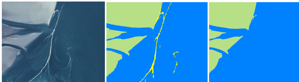
Schuimkoppen op het water (links), en shapefile voor (midden) en na (rechts) handmatige aanpassingen (komgebied Schild).
