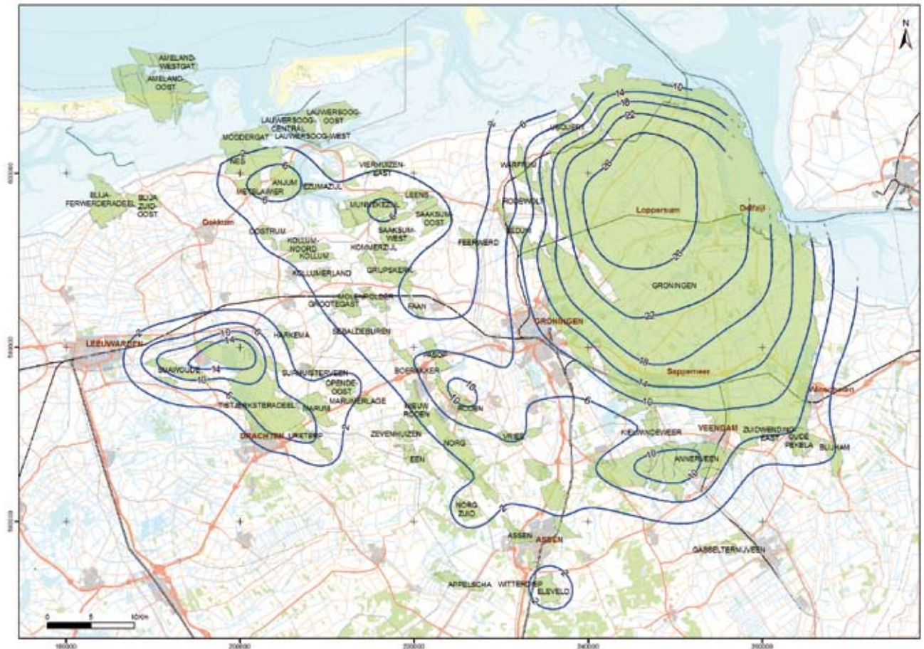
Figuur 5.11 Contourkaart voor bodemdaling door gaswinning opgetreden tussen start van de productie en de waterpassing in 2008, bepaald met het aan de metingen gekalibreerde geomechanisch model.
