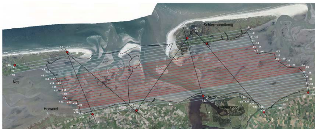
Figuur 3.6 Administratie en datum van acquisitie van de vlieglijnen gevlogen voor de opname van voorjaar 2016. Blauwe lijnen zijn gevlogen op 5 mei, rode lijnen op 6 mei. De vliegbanen die de productiebanen kruisen zijn dagelijks gevlogen (Eurosense, 2016c).
