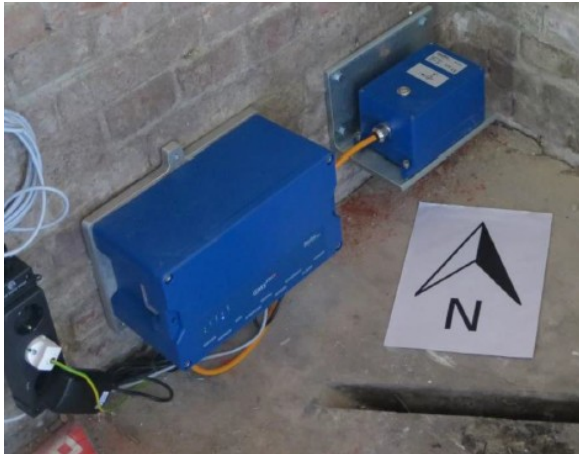
Vibration monitoring system. Links de gebouwen-sensor-recorder en rechts de gebouwen-sensor zelf.
