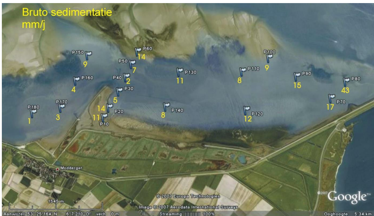
Figuur 25. Sedimentatiesnelheid per meetstation voor het onderzoeksgebied Paesens in de periode 2007-2016 in mm/jaar (gele cijfers). Data bijgewerkt tm 2016.
