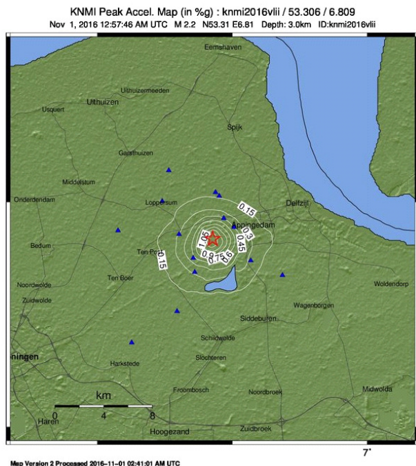
Figuur 7 ShakeMap van de aardbeving bij Wirdum op 1 november 2016, op basis van gemeten data en de voor Groningen opgestelde Ground Motion Prediction Equation (v2). De waarden zijn weergegeven in procenten-g [%g] waarbij g = 980.665 \text{ cm/s}^2
