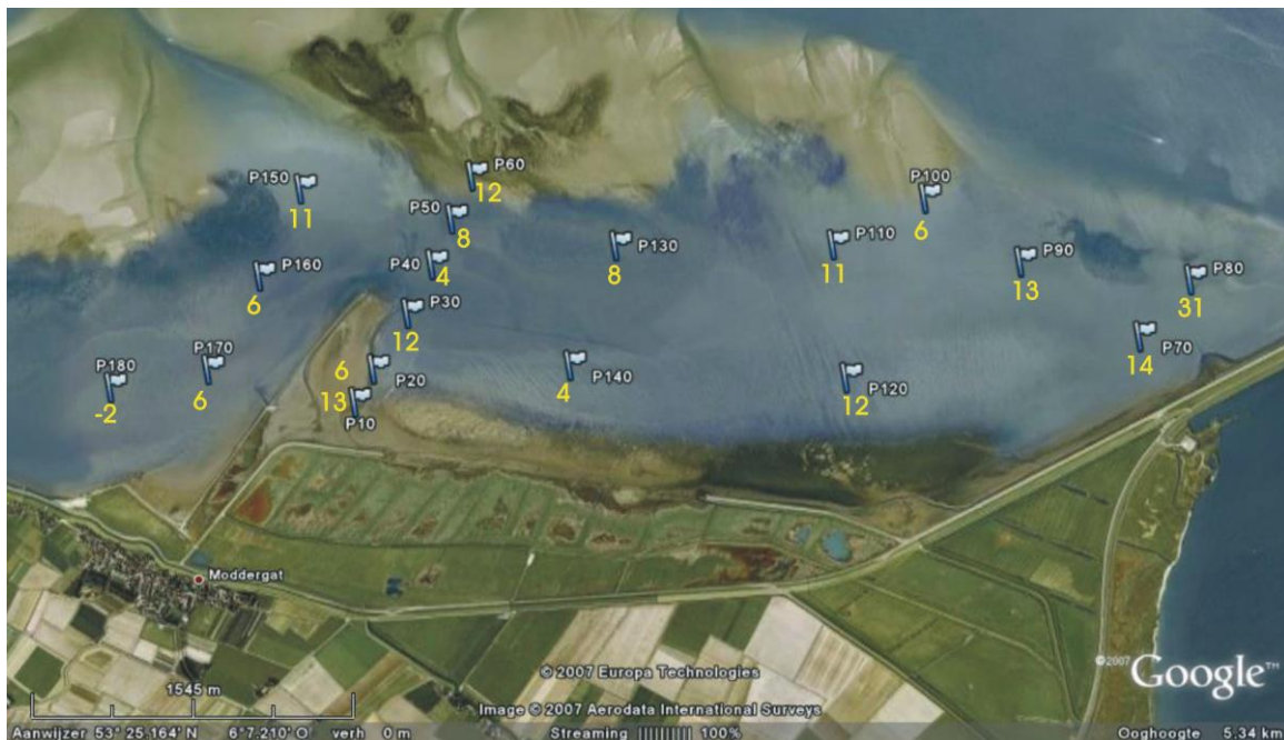
Figuur 25. Sedimentatiesnelheid per meetstation voor het onderzoeksgebied Paesens in mm/jaar (gele cijfers). Data bijgewerkt tm 2014.
