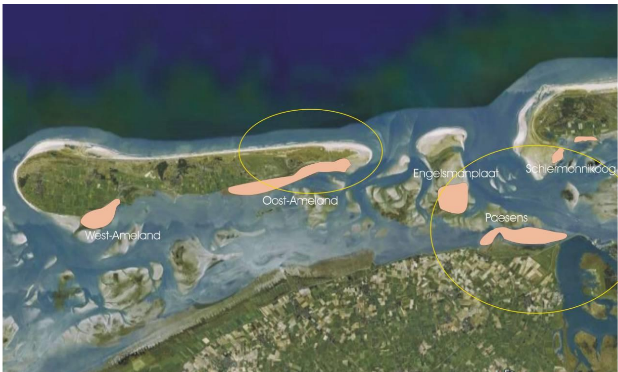
Figuur 11. Een overzicht van alle onderzoeksgebieden op een luchtfoto (Google) ingetekend. De gele lijn geeft ruwweg de buitengrens van de twee dalingschotels vanwege gaswinning aan. De schotel van Oost-Ameland is daadwerkelijk. De voor de winning bij Paesens/Lauwersoog voorspelde maximale contour is ruwweg getekend. Hier binnen is tm 2014 alleen in het onderzoeksgebied Paesens sprake van daling van de diepe ondergrond.
