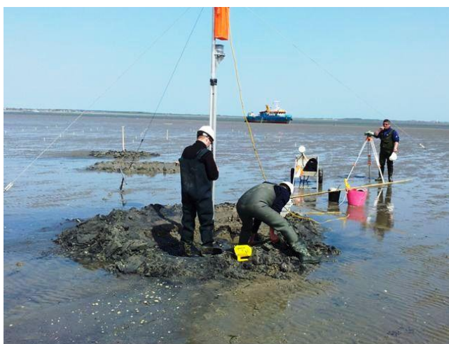
Figuur 2 – Voorbeelden van peilmerken op Ameland. Linksboven: een bout in de muur van een gebouw (Bron: Rijkswaterstaat); Rechtsboven: in de duinen een diep in de grond geslagen paal (Bron: Rijkswaterstaat); Linksonder: een peilmerk in de bodem van de Waddenzee; Rechtsonder: het plaatsen van een tijdelijk GPS-station op een peilmerk in de Waddenzee. Hier wordt een paar dagen met behulp van GPS het niveau van een peilmerk zorgvuldig gemeten. Uit het verschil in hoogte tussen alle gemeten peilmerken wordt met landmeetkundige methodes de bodemdaling in kaart gebracht.
