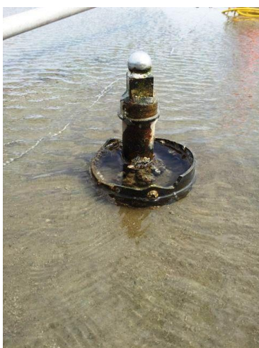
Figuur 2 – Voorbeelden van peilmerken op Ameland. Linksboven: een bout in de muur van een gebouw (Bron: Rijkswaterstaat); Rechtsboven: in de duinen een diep in de grond geslagen paal (Bron: Rijkswaterstaat); Linksonder: een peilmerk in de bodem van de Waddenzee; Rechtsonder: het plaatsen van een tijdelijk GPS-station op een peilmerk in de Waddenzee. Hier wordt een paar dagen met behulp van GPS het niveau van een peilmerk zorgvuldig gemeten. Uit het verschil in hoogte tussen alle gemeten peilmerken wordt met landmeetkundige methodes de bodemdaling in kaart gebracht.
