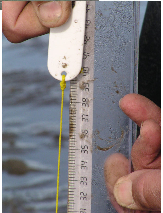
Figuur 5. Meetlineaal met meetvoet. Deze wordt steeds op dezelfde wijze op de bodem gezet waarna de lengte van het meettouw langs de schaal wordt afgelezen.
